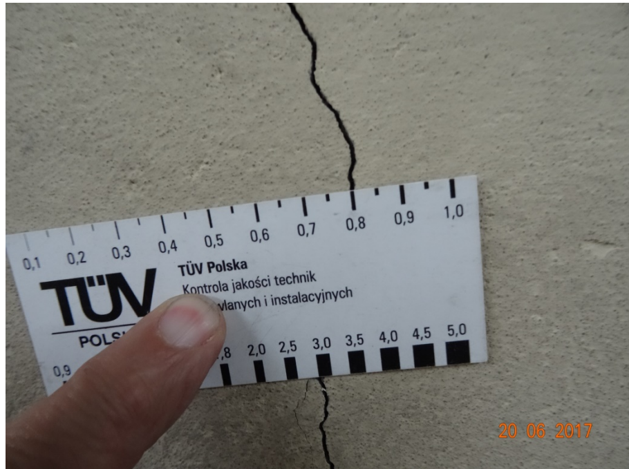
Fot. 57. Jak fot. 56, lecz pomiar rozwartości rysy.
