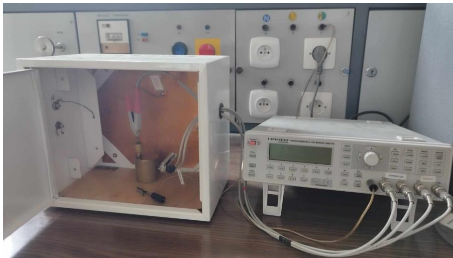
Rys. 37. Układ pomiarowy do badania pojemności izolatora
