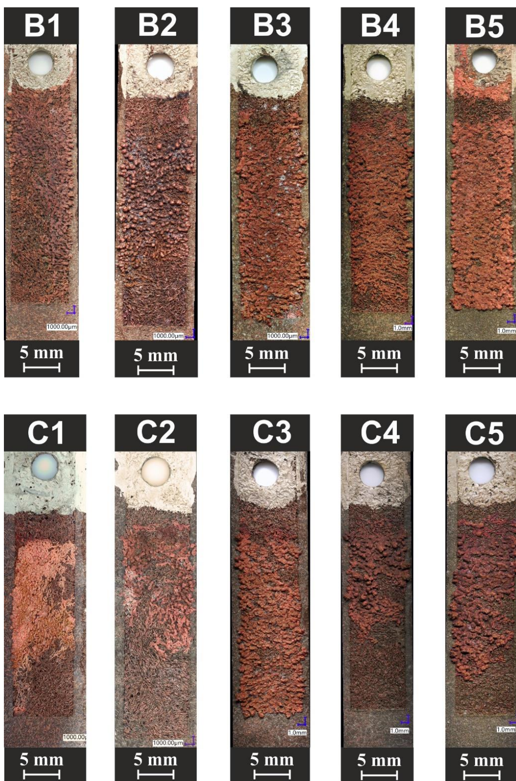
Rys. 97. Efekty metalizowania prądowego opracowanego kompozytu uprzednio modyfikowanego laserem Jasper X0-20
