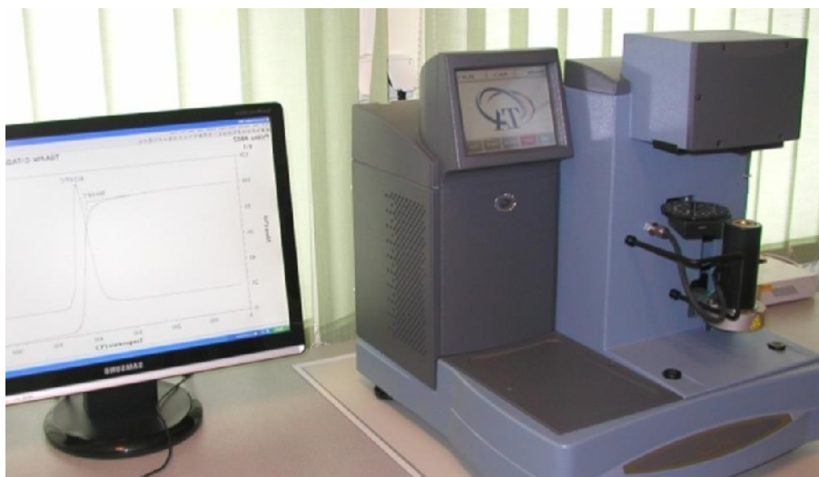
Rys. 21. Stanowisko pomiarowe do badań termograwimetrycznych
