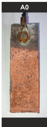
Rys. 72. Widok próbki A0 po metalizacji
