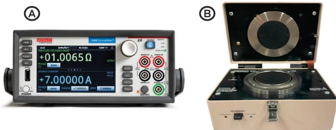
Rys. 30. Układ pomiarowy do wyznaczania rezystywności powierzchniowej: a) źródło napięcia/prądu SMU 2460 (Keithley, USA); b) zestaw elektrod 8009 (Keithley, USA)
