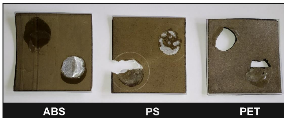
Rys. 52. Widok rezultatów badania wytrzymałości połączeń adhezyjnych wybranych materiałów.
