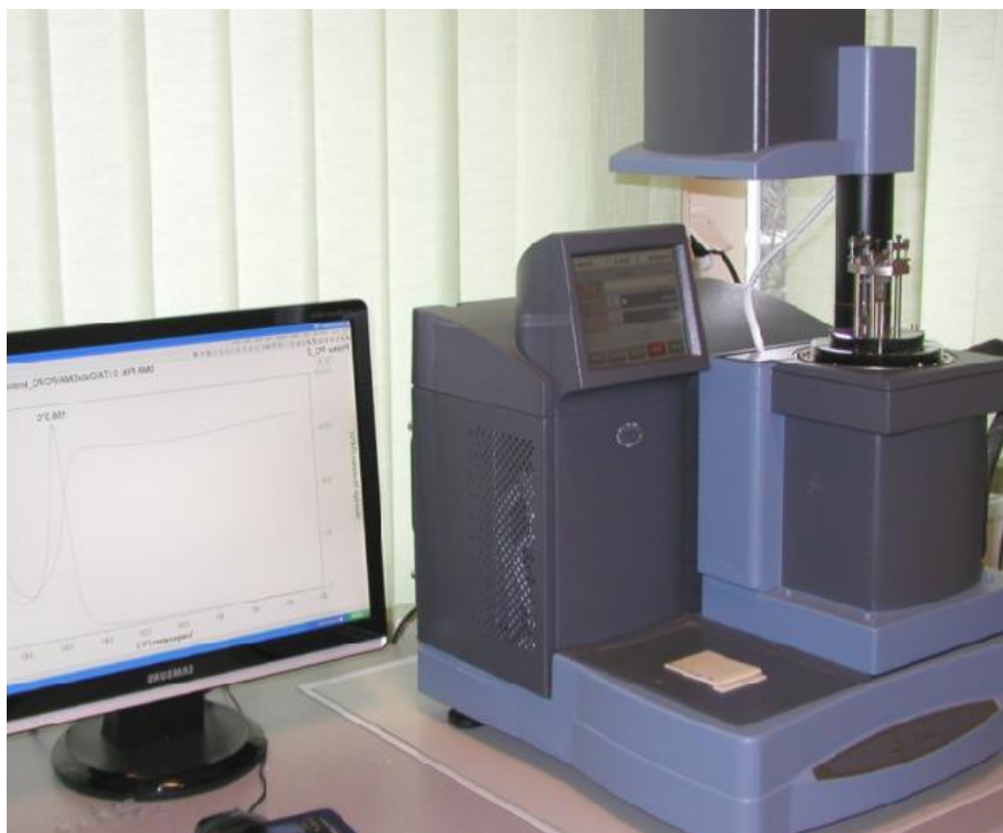
Rys. 24. Stanowisko do badań dynamicznej analizy mechanicznej
