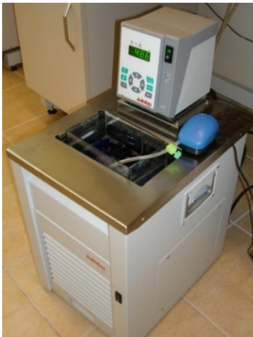
Rys. 5.21. Cyrkulator grzewczo-chłodzący F32-MC wraz z naczyniem kąpieli miedziującej
