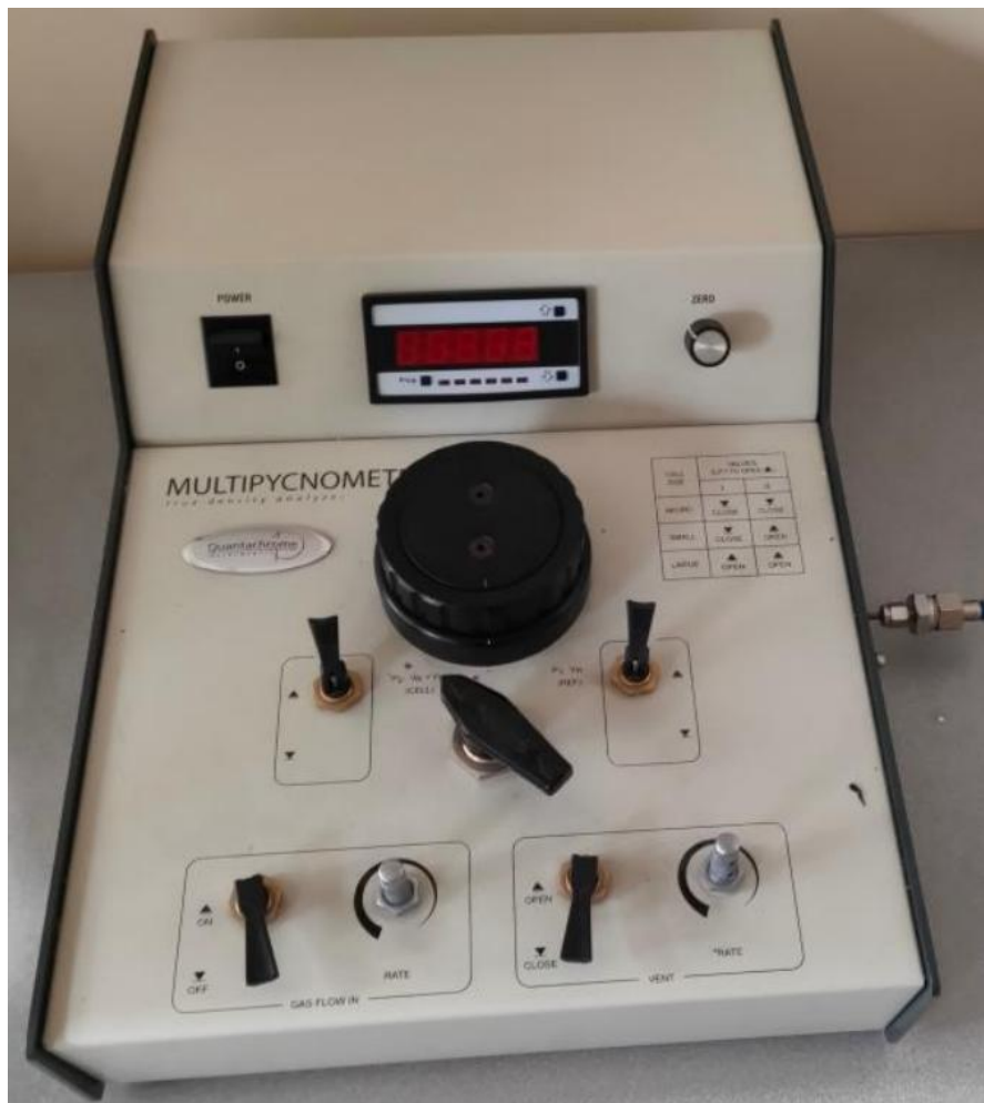
Rys. 5.10. Stanowisko do badania gęstości
