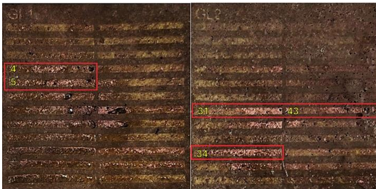
Rys. 6.16. Efekty metalizowania bezprądowego kompozytu PLA_MTA30 po 60 min
