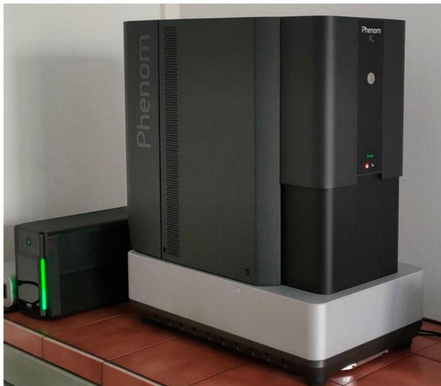
Rys. 5.22. Mikroskop skaningowy Phenom XL
