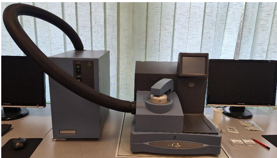
Rys. 5.12. Stanowisko do badań metodą różnicowej kalorymetrii skaningowej
