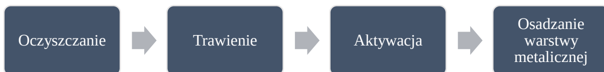
Rys. 1.4. Schemat kolejnych etapów przygotowania powierzchni polimeru do metalizowania bezprądowego: oczyszczanie, trawienie, aktywacja oraz osadzanie warstwy metalicznej
