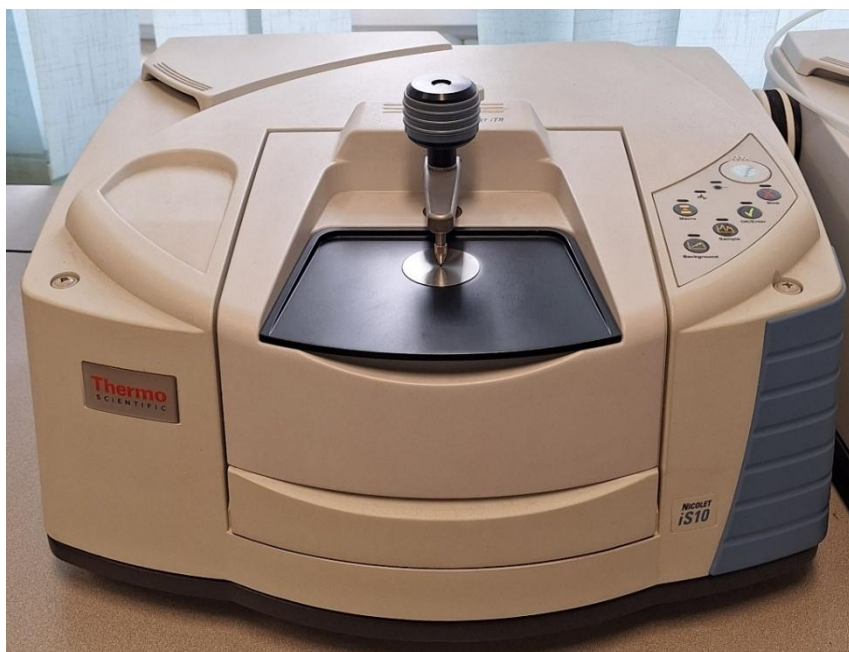
Rys. 5.13. Spektrofotometr Nicolet iS10 do badań FTIR z przystawką ATR
