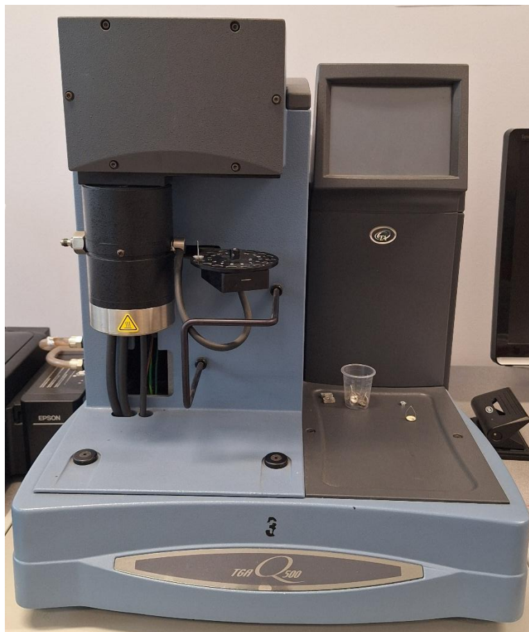
Rys. 5.11. Stanowisko do analizy termograwimetrycznej
