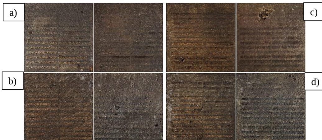
Rys. 6.18. Efekty metalizowania bezprądowego próbek: a) ABS_MDAg10, b) ABS_MDAg20, c) ABS_MTAg10, d) ABS_MTAg20 (60 min)
