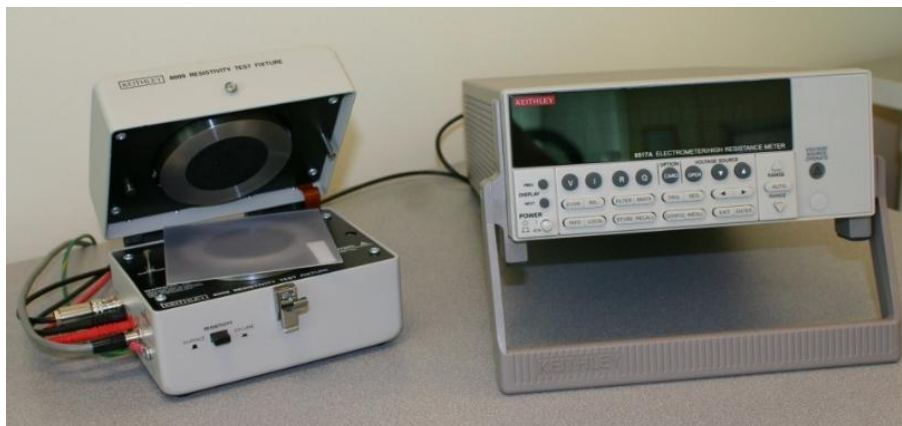
Rys. 5.24. Elektrometr 6517A z zestawem elektrod do pomiaru rezystywności
