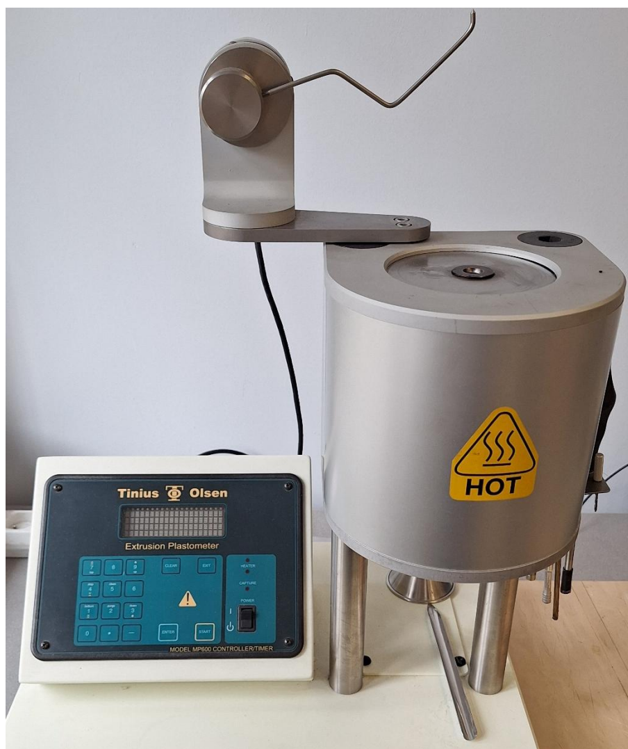
Rys. 5.14. Plastometr kapilarny MP600 do badań MFR
