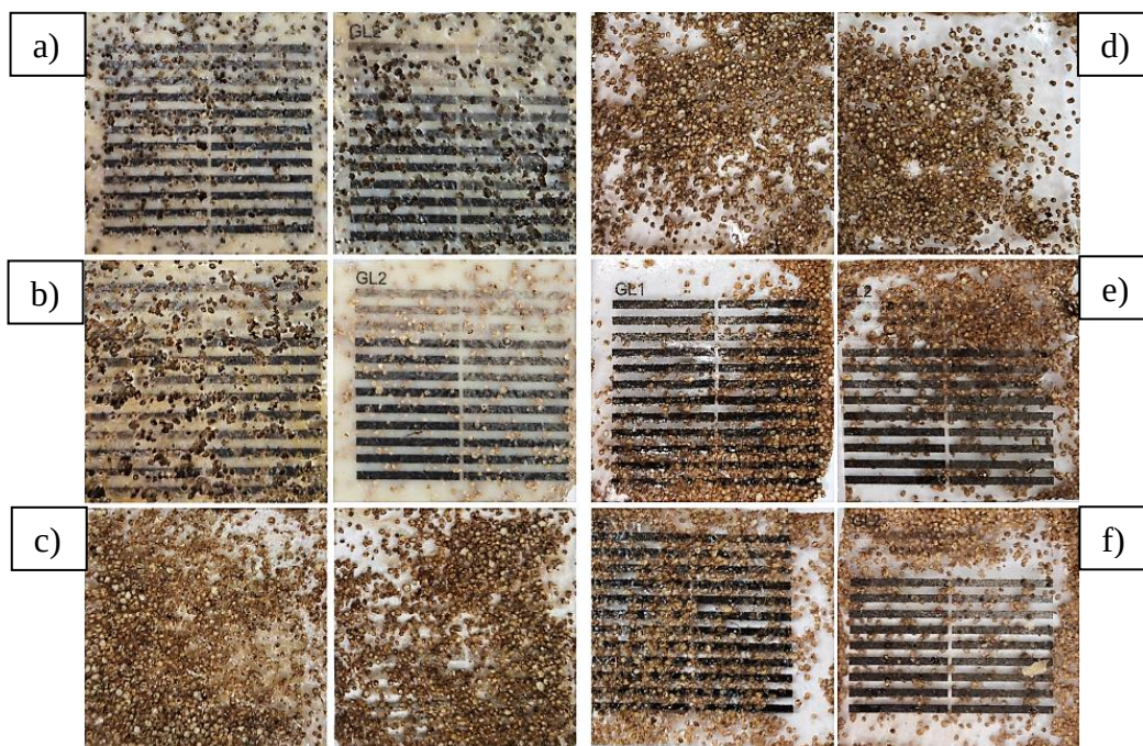
Rys. 6.20. Brak korzystnych efektów metalizowania bezprądowego wybranych próbek zawierających mikrosfery z grupy M2: a) ABS_M2DAG30, b) ABS_M2TAG30, c) PLA_M2DAG30, d) PLA_M2TAG30, e) PS_M2DAG30, f) PS_M2TAG30
