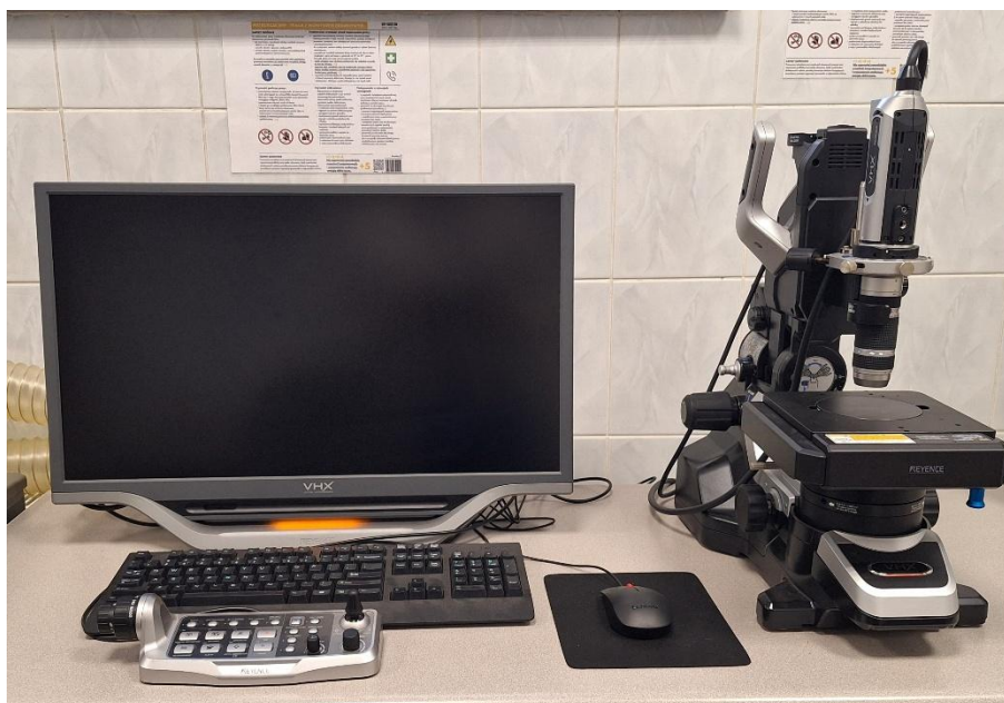
Rys. 5.23. Stanowisko do badań mikroskopowych i profilometrycznych
