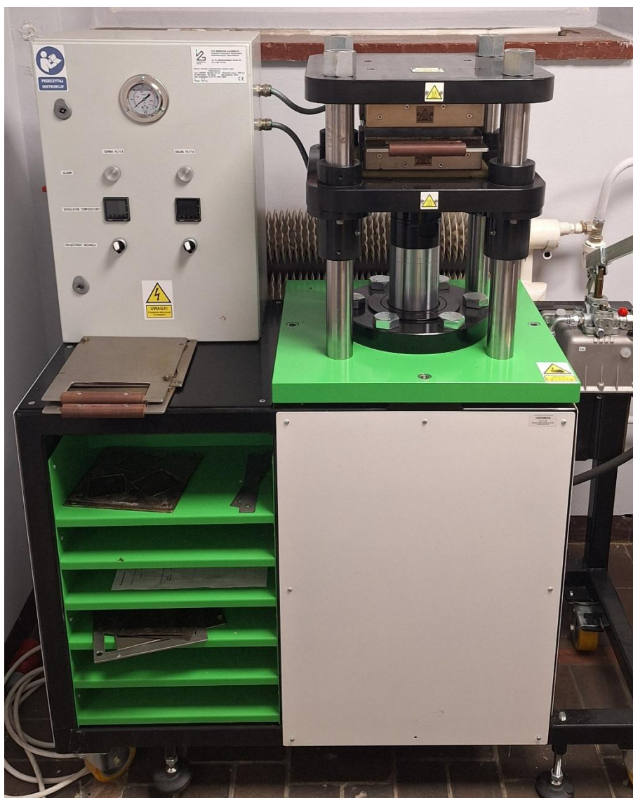
Rys. 5.9. Prasa hydrauliczna LAB200
