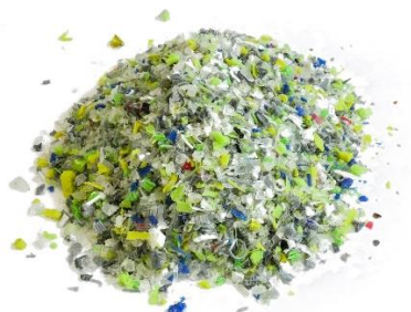
Rys. 20. Rozdrobniony PLA o wielkości ziarna poniżej 5 mm
