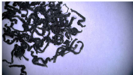
Rys. 6.67. Obrazy mikroskopowe po frezowaniu szerszej powierzchni przy głębokości 0,5 mm: a, b) stan powierzchni i krawędzi; c, d) zebrany urobek. Lewa kolumna — PLA LX175, prawa — kompozyt PLA/E90/CP.
