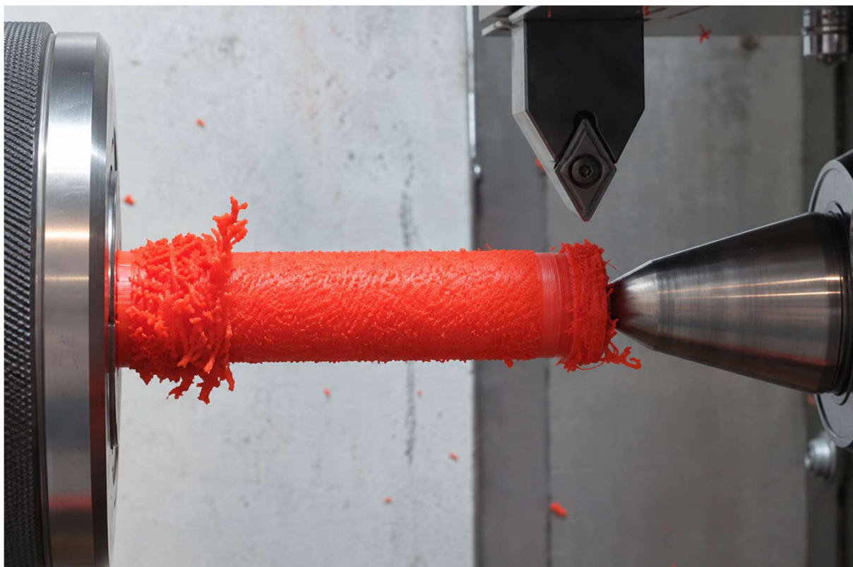
Rys. 2.28. Przykład niejednorodnej powierzchni elementu z PLA powstałej podczas toczenia przy V_c = 50\text{m/min} i f = 0,05\text{ mm/obr.} Źródło: Bañon-Garcia i wsp. [251], fragment ryciny, wykadrowano. Licencja CC BY 4.0.
