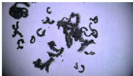
Rys. 6.69. Obrazy mikroskopowe po frezowaniu węższej powierzchni przy głębokości 0,5 mm: a) górny obraz — porównanie krawędzi, kompozyt u góry i PLA u dołu; b) wióry PLA; c) wióry kompozytu. Odrębne wióry występowały w obu materiałach.
