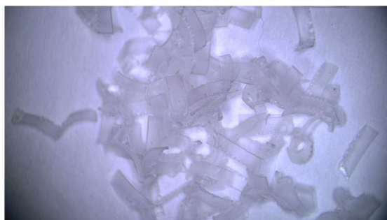
Rys. 6.70. Obrazy mikroskopowe po frezowaniu węższej powierzchni przy głębokości 1 mm: a) górny obraz — porównanie krawędzi, PLA u góry i kompozyt u dołu; b) wióry PLA; c) wióry kompozytu. Zestawienie nie stanowi porównania wymiarów wiórów.
