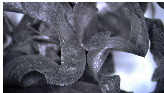
Rys. 6.66. Wióry kompozytu nr 11 uzyskane podczas wiercenia: a) widok ogólny; b) szczegóły zwiniętych fragmentów wstęgowych. Widoczne są również drobniejsze odłamki
