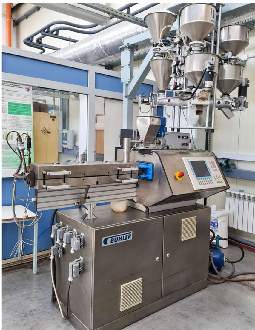
Rys. 2.20. Laboratoryjna współbieżna wylączarka dwuślimakowa z układem dozowania surowców, zastosowana w procesie wytwarzania badanych kompozytów. Fotografia własna.
