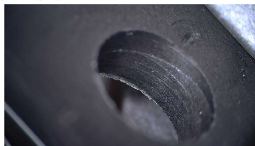
Rys. 6.65. Obrazy mikroskopowe otworów po wierceniu: a, c) niemodyfikowany PLA LX175; b, d) kompozyt PLA/E90/CP. Górny rząd przedstawia widok otworów i ich otoczenia, dolny — szczegóły ścianek i krawędzi. Próbki bez usuwania zadziorów i pozostałości wiórów.
