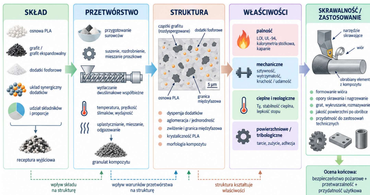
Rys. 2.30. Schemat zależności między składem i warunkami przetwórstwa kompozytu na osnowie PLA a jego strukturą, właściwościami użytkowymi, skrawalnością oraz potencjalnym zastosowaniem. Opracowanie własne.
