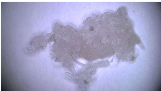
Rys. 6.67. Obrazy mikroskopowe po frezowaniu szerszej powierzchni przy głębokości 0,5 mm: a, b) stan powierzchni i krawędzi; c, d) zebrany urobek. Lewa kolumna — PLA LX175, prawa — kompozyt PLA/E90/CP.
