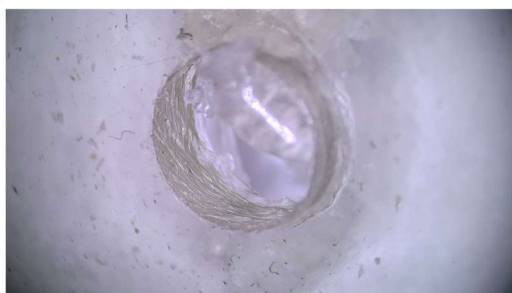
Rys. 6.65. Obrazy mikroskopowe otworów po wierceniu: a, c) niemodyfikowany PLA LX175; b, d) kompozyt PLA/E90/CP. Górny rząd przedstawia widok otworów i ich otoczenia, dolny — szczegóły ścianek i krawędzi. Próbki bez usuwania zadziorów i pozostałości wiórów.
