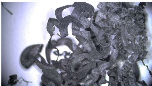
Rys. 6.66. Wióry kompozytu nr 11 uzyskane podczas wiercenia: a) widok ogólny; b) szczegóły zwiniętych fragmentów wstęgowych. Widoczne są również drobniejsze odłamki
