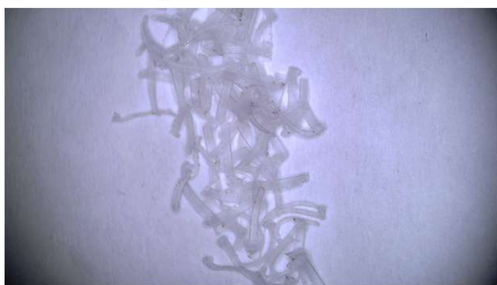
Rys. 6.69. Obrazy mikroskopowe po frezowaniu węższej powierzchni przy głębokości 0,5 mm: a) górny obraz — porównanie krawędzi, kompozyt u góry i PLA u dołu; b) wióry PLA; c) wióry kompozytu. Odrębne wióry występowały w obu materiałach.
